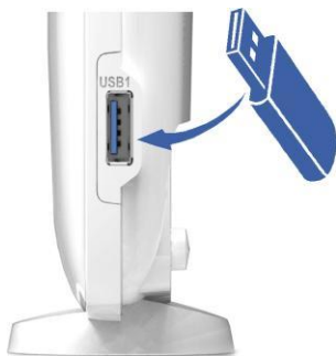
Рис. 7 Подключение USB-устройства хранения данных
